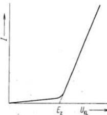
Stromfluss als Funktion der externen Spannung bei der Elektrolyse einer Lösung. Oberhalb der Zersetzungsspannung beginnt die Abscheidung bzw. Zersetzung. Der geringe Stromfluss unterhalb ist auf Aufbau einer Gegen-EMK und Abdiffusion zurückzuführen.
