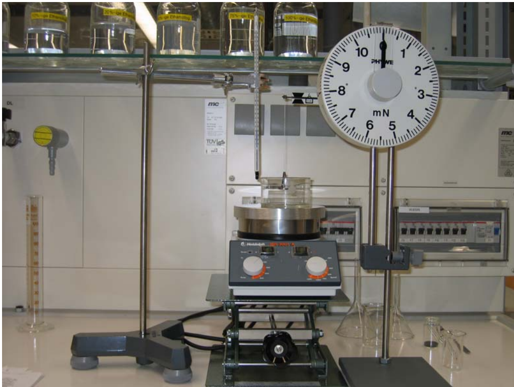
Abb. 2: Apparatur zur Bestimmung der Oberflächenspannung nach Du Nuoy
